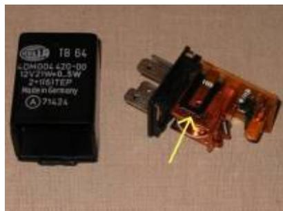
Der U-förmige Strommesswiderstand ist bei diesem Blinkrelais oberhalb der Relaispule zu erkennen.
